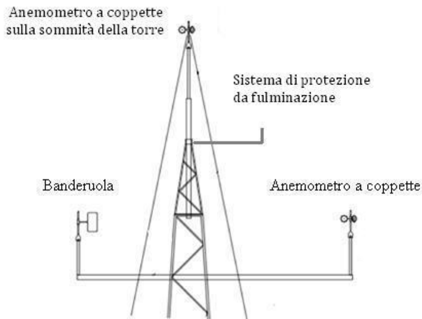
Fig. 1 - Layout generale di una torre anemometrica con struttura a traliccio
